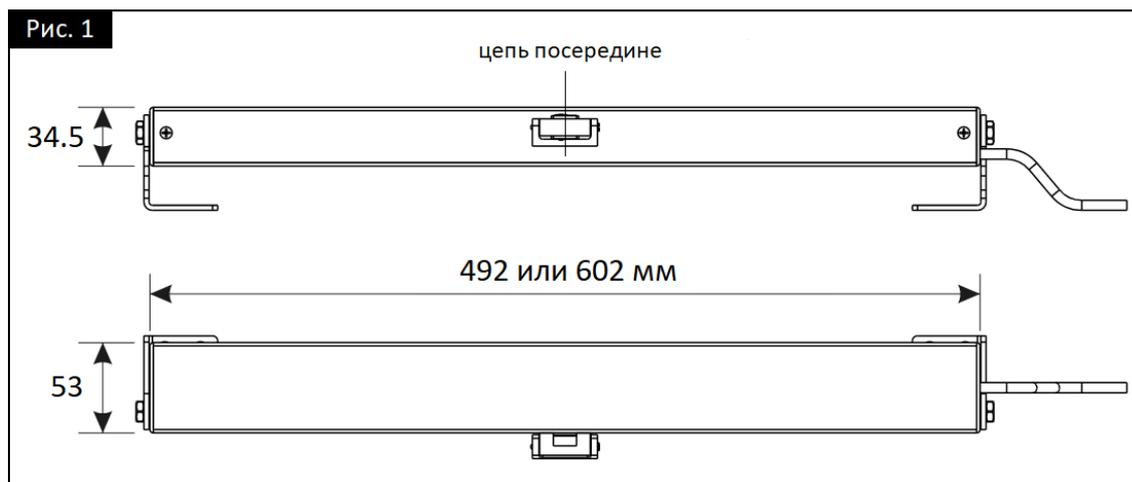
Габаритные размеры электропривода показаны на рис. 1.
